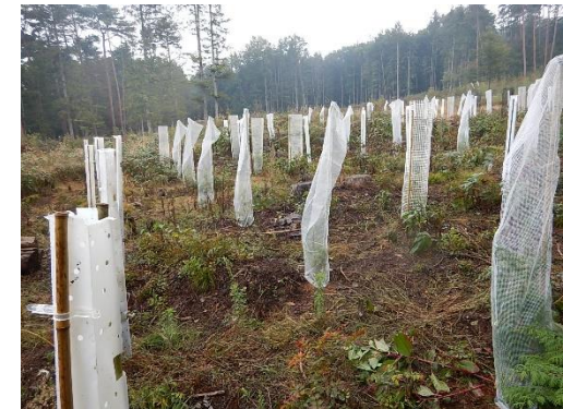
鳥獣害対策資材の現地試験 (長野県林業総合センター構内の植栽木へ設置)
