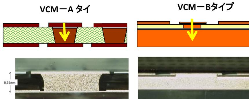
左図はVCM配線板の断面だが、どちらも銅のポストで配線板の裏面側に、矢印のように速やかに熱を伝えることができる。
